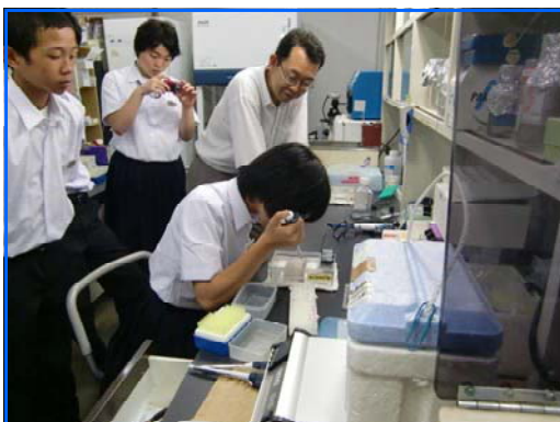
【ピペットマンを使ってアガロースを注入する作業】
